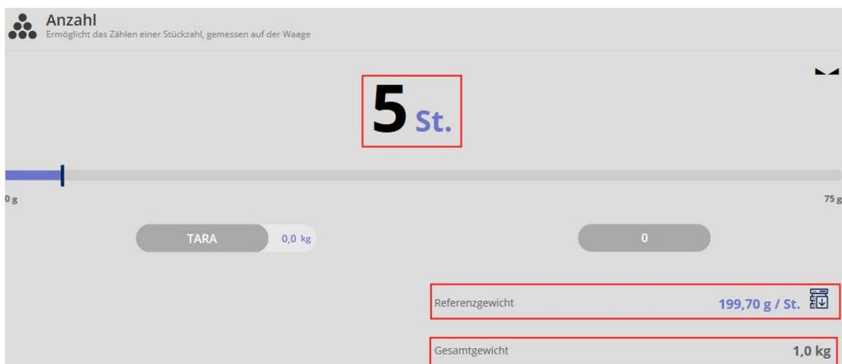
Zum Zählen Wägeplatte entlasten und Teile auflegen. Die Anzahl der aufgelegten Teile wird angezeigt, sowie das Referenzgewicht und das Gesamtgewicht:
