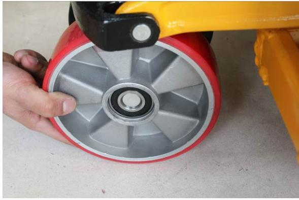
Установить самоустанавливающееся поворотное колесо с полиуретановым покрытием.
