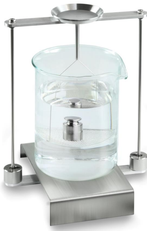
Fig. 2 : Pesée dans un liquide examiné
