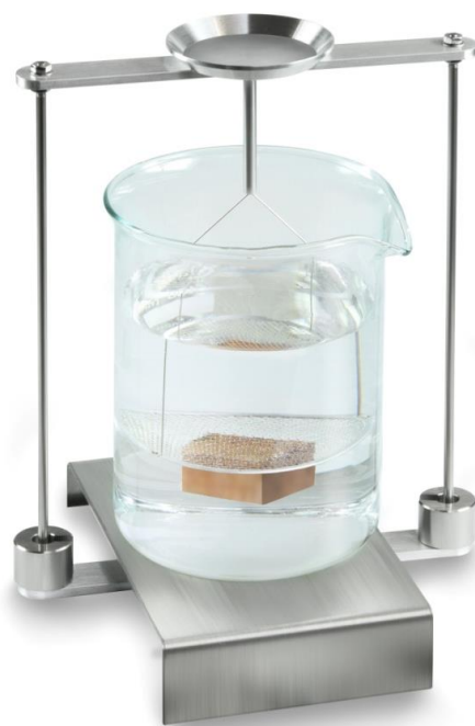
Fig. 4: Pesée dans un liquide auxiliaire
