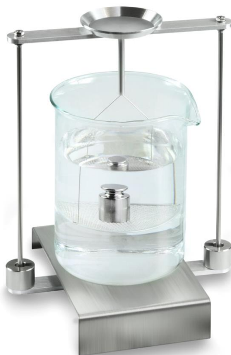
Fig. 2 : Pesée dans un liquide auxiliaire
