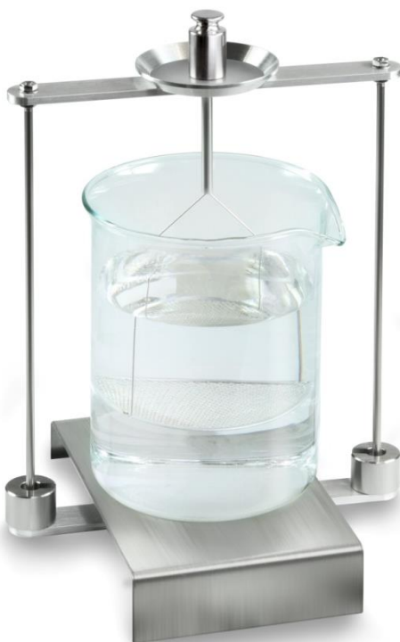
Fig.1: Pesée dans l'air
