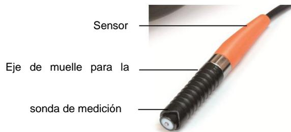
El sensor debe tocarse en el segmento inferior del eje y sólo se presiona ligeramente sobre el objeto de prueba.
