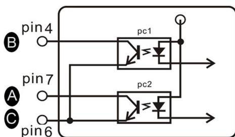
Les broches 6 et 7 sont activées après le déclenchement de l'alarme de surcharge. En mode réglage, les broches 6 et 7 sont allumées après le dépassement de la valeur limite supérieure, et les broches 4 à 6 - après le sous-dépassement de la valeur limite inférieure.
