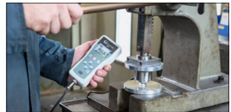
Medidor digital universal de fuerza con asistencia gráfica y célula de carga integrada
