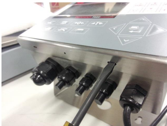
Figura 1-2: Apertura de la caja para ambientes adversos
