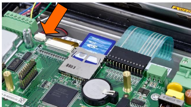
Figura 5-6: Inserción de la tarjeta de memoria SD
