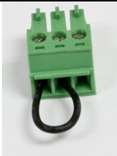
Figura 5-3: Cable de puente entre los terminales de transmisión y recepción COM1
