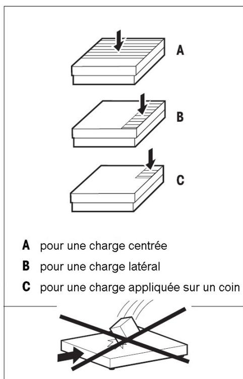
⇒ Eviter la mise en place brutale d'une charge, les secousses ainsi que les chocs latéraux.
