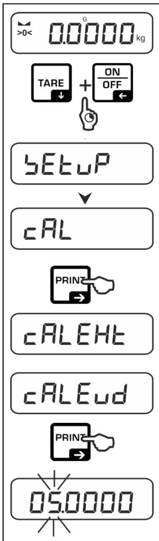
⇒ Pour appeler le menu de configuration, appuyer simultanément sur les touches TARE et ON/OFF et les maintenir enfoncées.
