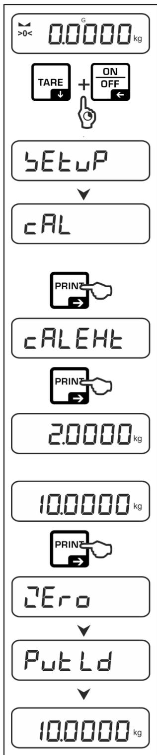
⇒ Pour appeler le menu de configuration, appuyer simultanément sur les touches TARE et ON/OFF et les maintenir enfoncées.
