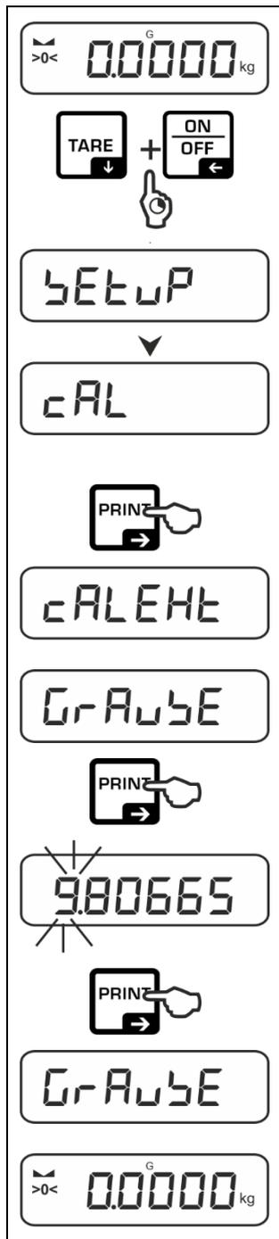
⇒ Pour appeler le menu de configuration, appuyer simultanément sur les touches TARE et ON/OFF et les maintenir enfoncées.
