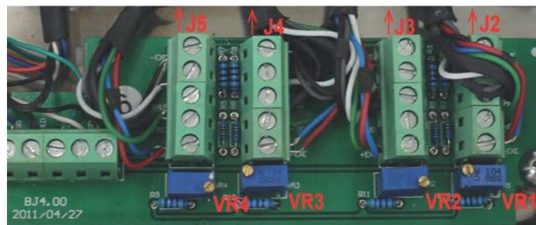
L'ajustage de la cellule de pesée J2 s'effectue sur de potentiomètres VR1.
