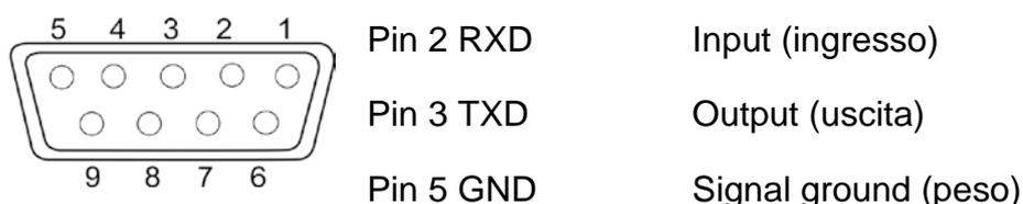
Velocità di trasmissione                    possibilità di selezionare 4800/9600
