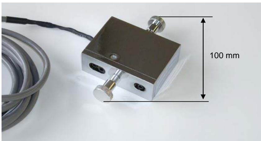
Externer Sensor mit Zubehör für Drucktests.
