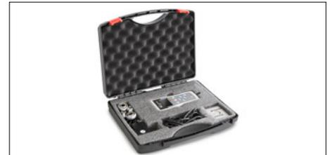
◀ **Nota:** La célula de medición mostrada no está incluida en el volumen de suministro. Combine el FL TM con una célula de medición de la gama SAUTER adecuada para su aplicación, como CR P1, CR Q1, CS P1 o CS Q1, etc.
