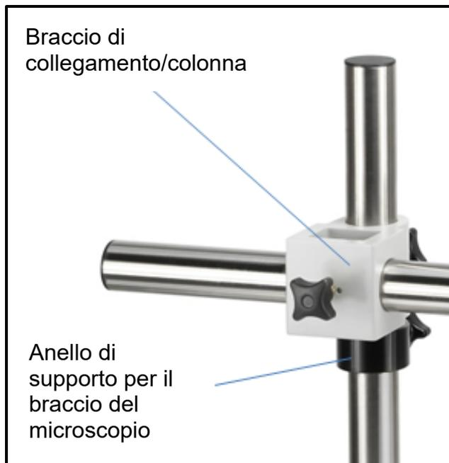
Fissare il braccio del microscopio
