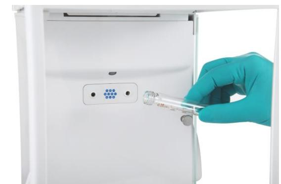
Ionizér generuje bipolární continuity nabitého částic. Tyto částice pak vybíjí na vhondom povrchu a tím eliminuje statické napětí. Eliminace statického napětí napomáhá k dosažení přesnějších výsledků.
