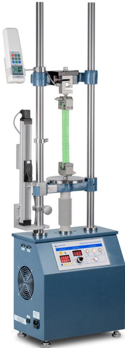
Banc d'essai de qualité premium avec moteur pas-à-pas pour un contrôle précis jusqu'à 50 kN
