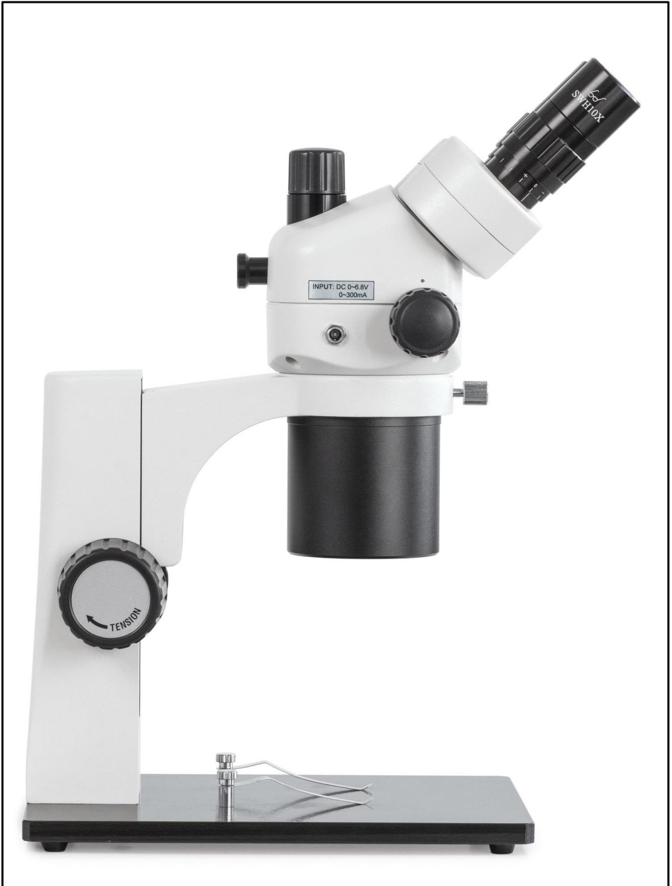
Fertig zusammengebautes Stereo-Zoom-Mikroskop
