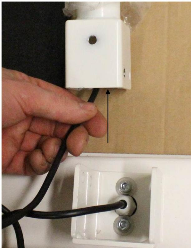
Das Kabel im Stativrohr verschwinden lassen
