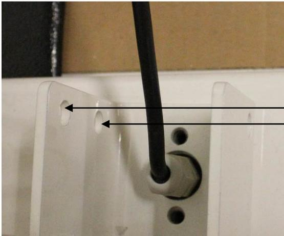
Anschlußkabel lt. Abbildungen durchführen und an der Lastzelle anschließen.
