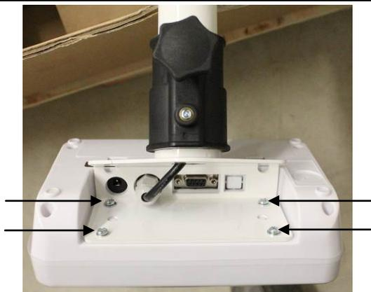
Anzeigegerät mit den 4 kleinen Schrauben aus der Tüte an der Stativhalterung anschrauben.
