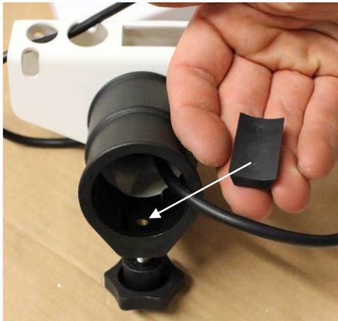
Gummiabdeckung lt. Abb. in die Stativhalterung drücken
