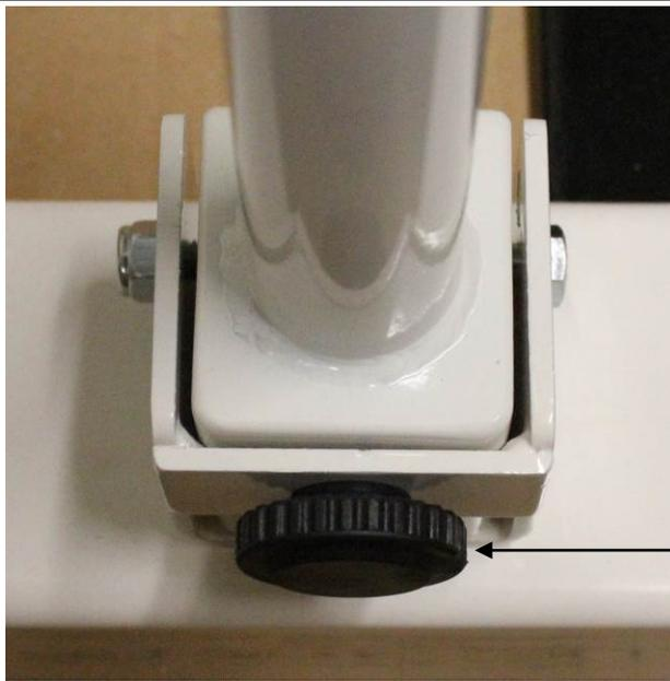
Rohre hochklappen und mit den 2 schwarzen Schrauben fixieren.
