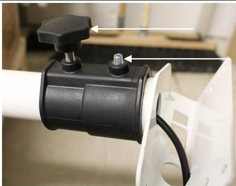
Stativhalterung auf das Stativrohr stecken und mit Schrauben lt. Abb. fixieren
