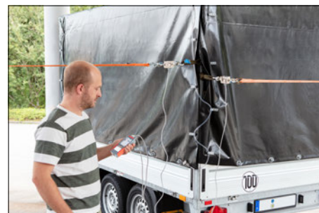
Mesure des forces dans différentes directions de traction ou de compression, possible avec un seul appareil de mesure
